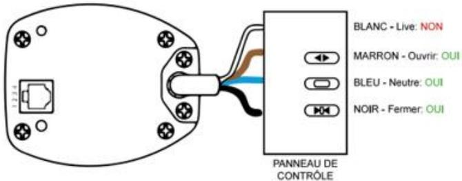
**CONNEXION AVEC FIL ÉLECTRIQUE : (INTERRUPTEUR MURAL/DOMOTICS ET A LA FOIS TÉLÉCOMMANDE) TOUCH&GO**
