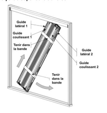
4) A l'aide d'un niveau à bulle, placez le corps Premium à gauche dans une position parfaitement verticale et marquez la position avec un crayon.
