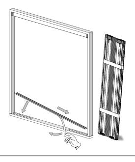
7) Placer la partie principale entre le traverse supérieure et le guide au sol.
