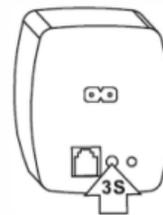
2-Appuyez avec un bâton fin sur le bouton en bas du moteur 3 secondes jusqu'à ce que la lumière du moteur s'allume
